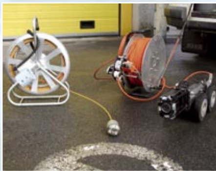
TV-Kanalkamera Caméra-TV pour canalisations
