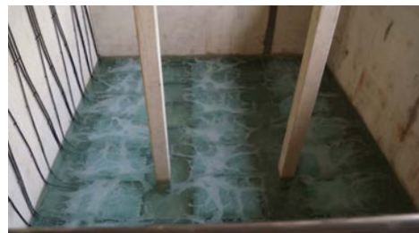
Test d'apport en oxygène / Sauerstoffeintragsversuch
