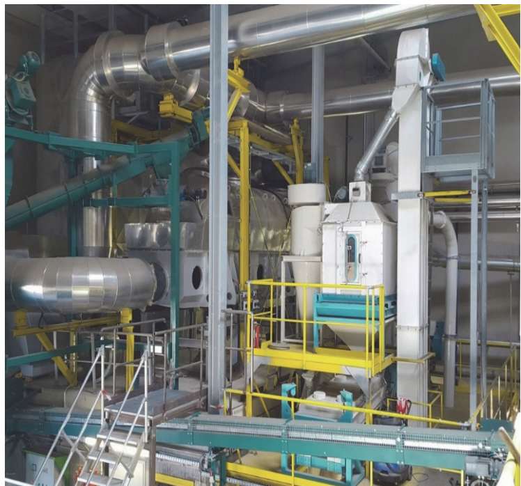
Vue sur l'unité de granulation (au milieu) et le sécheur vibrant à lit fluidisé (à gauche).
