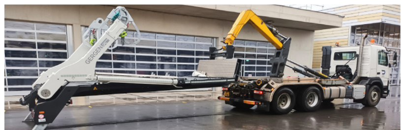
Plate-forme de levage pour conteneur à boues / Hebebühne für Schlammcontainer
