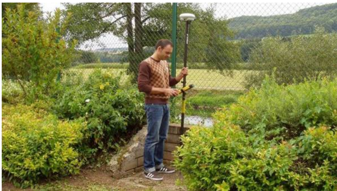
Photo: Levé topographique du terrain par GPS
