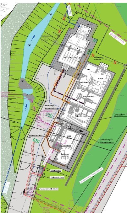
Lageplan Regenüberlaufbecken und Kläranlage
