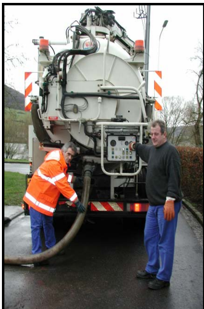
Transport vum flëssegem Klärschlamm
