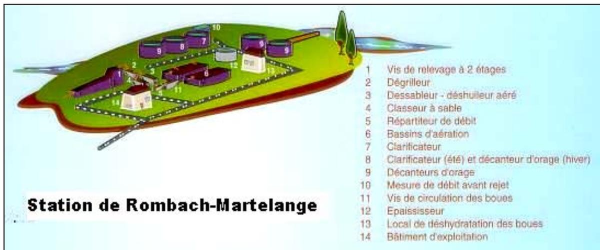
Schéma fonctionnel 3D de la station d'épuration
