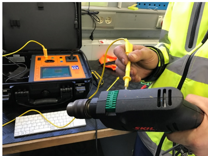
Abbildung 4: Durchführung einer Prüfung von Arbeitsmitteln
