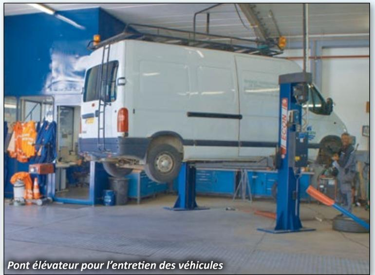
Pont élévateur pour l'entretien des véhicules
